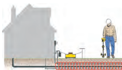
Conecte directamente con líneas de servicios públicos.
