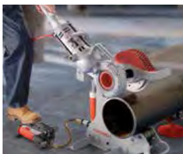
Cortatubos modelo 258 con impulsador motorizado N° 700 durante el corte.
