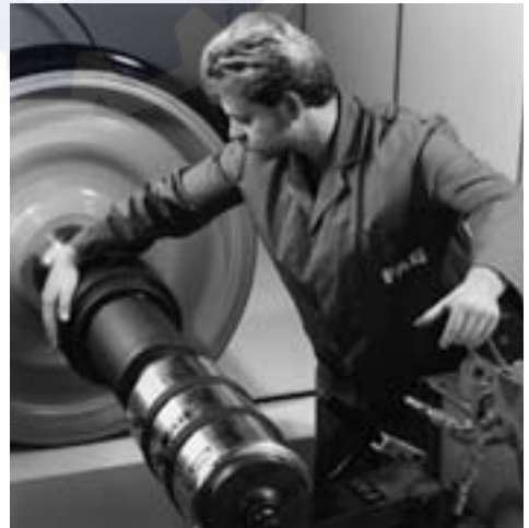
Montaje hidráulico de una unidad de rodamientos para ruedas TAROL sobre la mangueta
